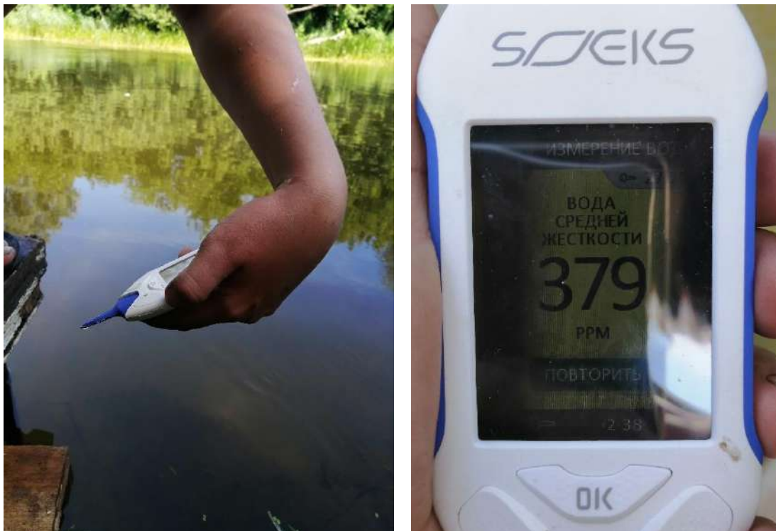
Рисунок 1. Замеры жесткости воды прибором СОЭКС Эквизор
