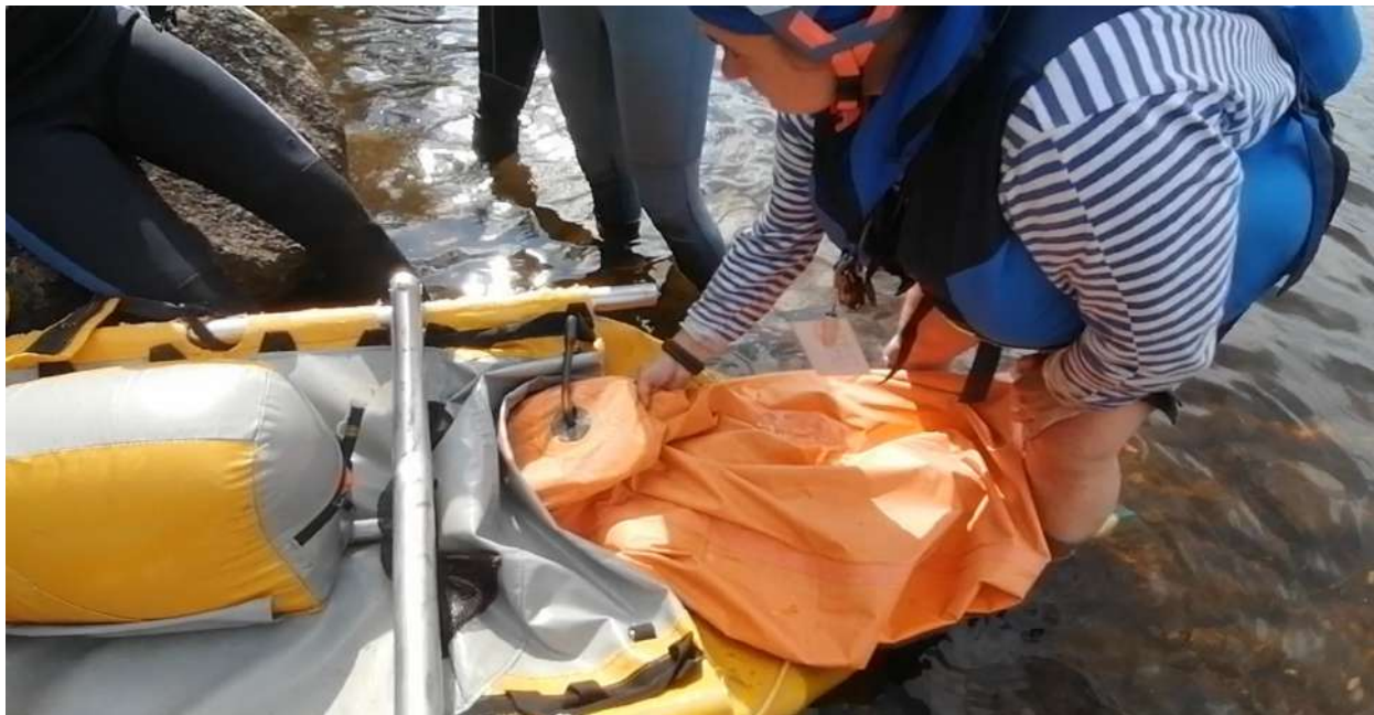
Фото 23. Ремонт штуцера внутрирки «Стерх-4» прямо на воде, на загруженном кате
